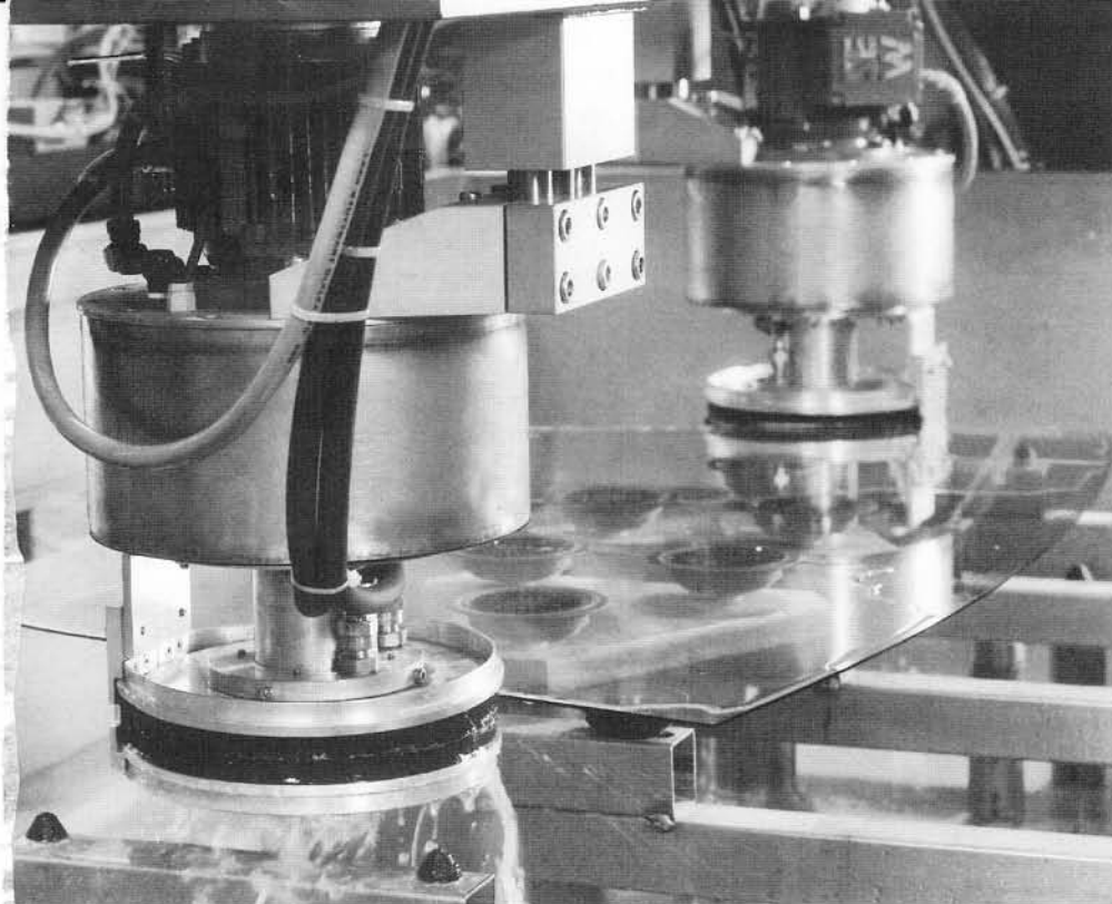
Automatische Anlage zur Kantenbearbeitung von Flachglas. Bild: Cimcorp
